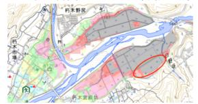
ここは、滋賀県の「地先の安全度マップ」によると100年確率で7メートル近く、200年確率で8メートル近くもの浸水が予想されるところです。さらには、山と山に挟まれてすぐ下流の荒川地先との間には高岩橋が架かっており、非常に川幅が狭く下流へ水が流れにくくなっています(狭窄部地形)。
